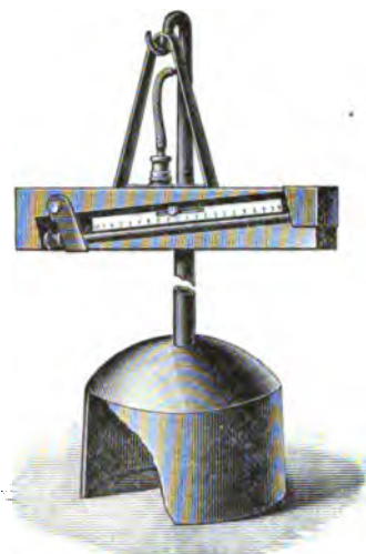
Fig. 77. — Indicateur de tirage modifié par Seger et Cramer.
